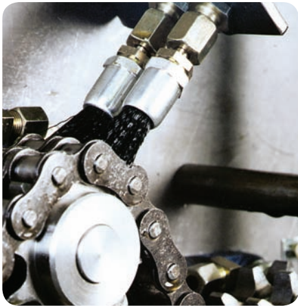
Смазка цепей при помощи щетки
